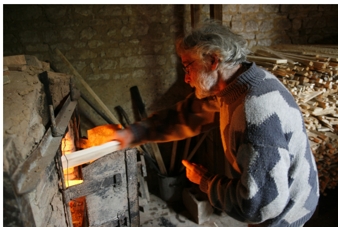
Alimentation du four à bois au cours de la cuisson des pièces une cuisson au four à bois
